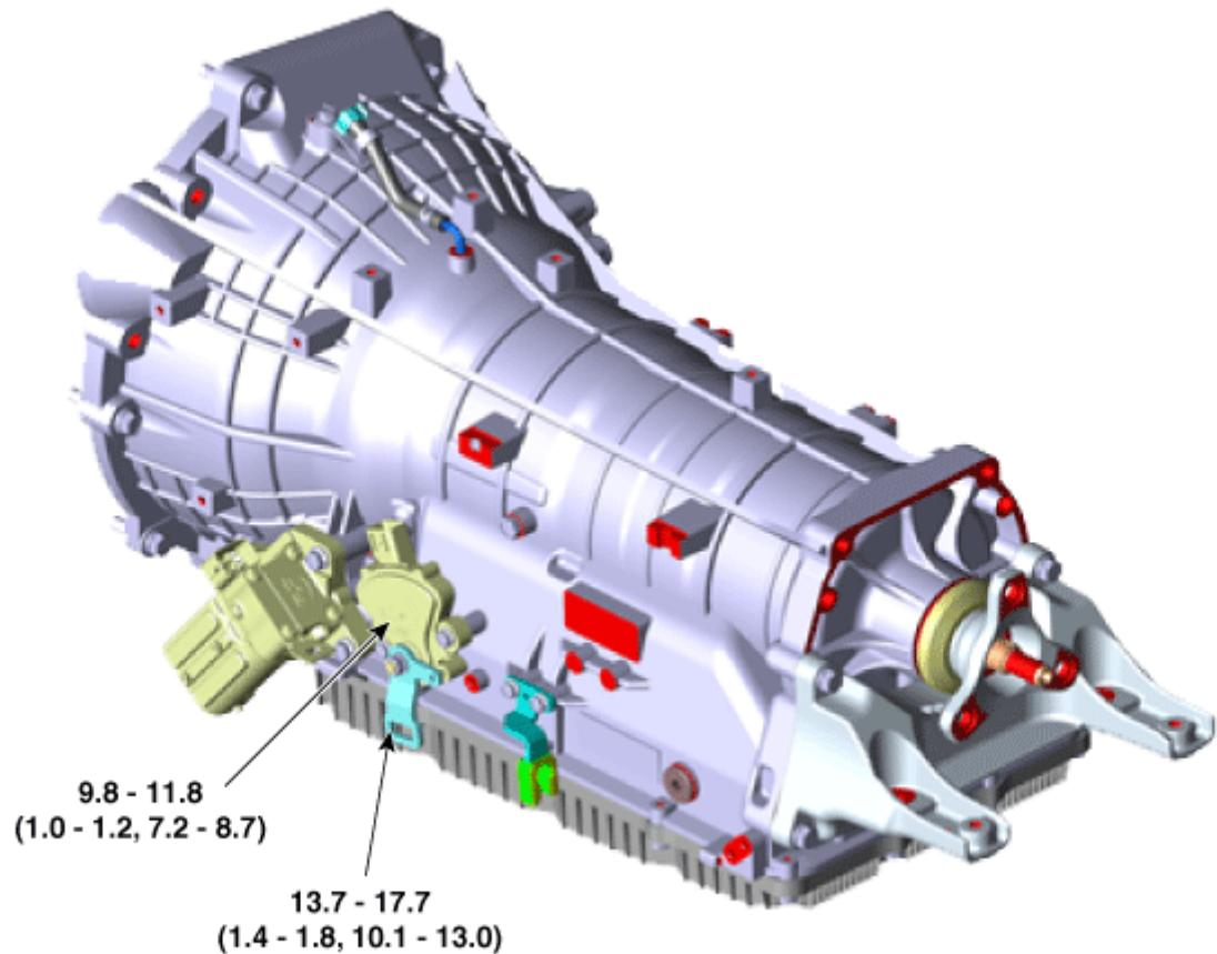
Tightening torque : N·m (kgf·m, lb·ft)
